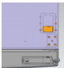
г) Ослабьте 1 винт, как показано на рисунке ниже, чтобы снять заглушку на верхней стороне прибора. Снимите маленькую торцевую заглушку на дверце и извлеките дверную втулку и кабельное соединение.
