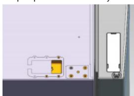
е) Поднимите дверцу холодильника примерно на 50 мм, чтобы снять ее с прибора.
