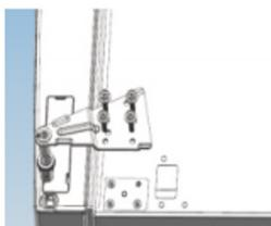
в) Вставьте дверную петлю и кабельное соединение в отверстие в двери, а затем прикрепите маленькую торцевую заглушку.
