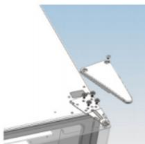
б) Отсоедините кабель. Открутите 4 винта, удерживающих верхнюю петлю, и снимите ее. Отсоедините заземляющий проводник петли. Вставьте разъем проводника в отверстие в верхней части прибора. Снимите дверную петлю и торцевые заглушки.
