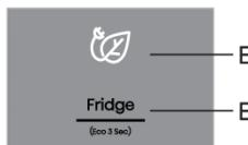
**Включение.** Чтобы включить режим **Eco**, нажмите и удерживайте (3 секунды) кнопку **E**. Загорится индикатор **E1**. В этом режиме прибор работает с наиболее оптимальными настройками.
