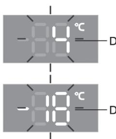
При превышении допустимой температуры в приборе включается прерывистый звуковой сигнал и на дисплее мигает значение заданной температуры отделения, в котором превышена температура.
