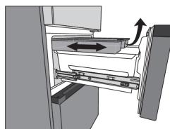
В каждом ящике в верхней части имеется лоток, который выдвигается при открывании ящика. Лоток можно задвинуть обратно внутрь или снять с ящика. Используйте лоток для хранения небольших упаковок продуктов или продуктов, которые вы часто используете, чтобы они были всегда под рукой.
