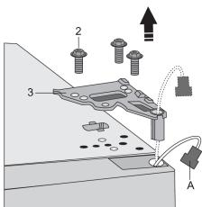
Открутите винты (2) и снимите шарнир (3). Извлеките коннектор (A) из отверстия шарнира. Придерживайте дверь, чтобы она не упала.
