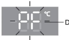
При отключении электроэнергии температура внутри прибора может превысить допустимый уровень. В этом случае после возобновления электроснабжения включится сигнализация о превышении допустимой температуры. Раздается звуковой сигнал, и на дисплее начнет мигать индикация **PF**.
