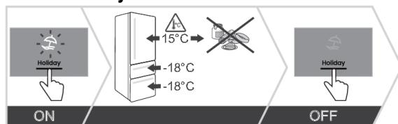
Режим «Отпуск» рекомендуется включать при отъезде на длительное время, например, в отпуск или длительную командировку.
