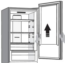
Приподнимите и аккуратно снимите дверцу со среднего шарнира. Положите дверцу на ровную поверхность.
