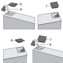
Снимите крышку (6) с левой стороны верхней дверцы. Затем снимите крышку (7) с правой стороны верхней дверцы. Установите крышку (7) с левой стороны верхней дверцы и крышку (6) с правой стороны.
