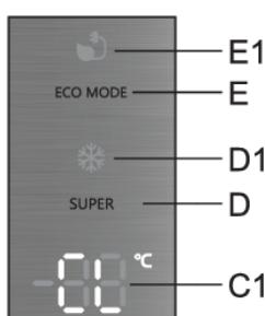
**Включение.** Чтобы включить защитную блокировку, нажмите и удерживайте (3 секунды) кнопку **E**. На дисплее **C1** на короткое время загорится индикация **CL**.
