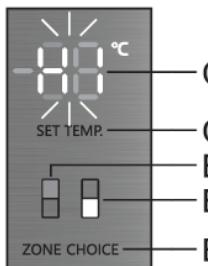
Если температура внутри прибора превышает допустимое значение, включается прерывистый звуковой сигнал. На дисплее **C1** начинает мигать индикация **HI** и загорается индикатор отделения, в котором превышена температура (**B1** или **B2**).
