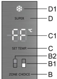
**Включение.** Нажмите кнопку **D**, чтобы включить функцию «Быстрое замораживание». Раздастся звуковой сигнал, и загорятся индикаторы **B1** и **D1**. На дисплее **C1** отображается **FF**: Если дисплей **B1** активировать кнопкой **B**, то значение **FF** отображается все время, пока включена функция.
