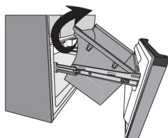
**Извлечение контейнера из нижнего ящика.** Приподнимите контейнер сзади и извлеките из ящика.
