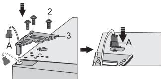
Отрегулируйте верхнюю дверцу, проденьте коннектор (A) через отверстие в верхнем шарнире (3) и винтами (2) прикрутите шарнир. Придерживайте при этом дверь рукой. Подсоедините коннектор (A).
