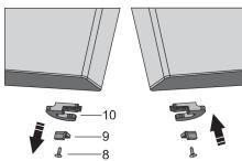
Открутите винт (8), снимите ограничитель двери (10) и упор двери (9). С помощью винта (8) прикрутите ограничитель двери, прилагаемый в пакете, и упор двери (9). Уберите ограничитель двери (10) на случай, если он понадобится в будущем.
