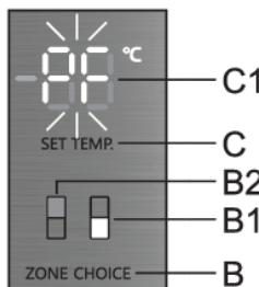
При отключении электроэнергии температура внутри прибора может превысить допустимый уровень. В этом случае после возобновления электроснабжения включится сигнализация о превышении допустимой температуры. Раздастся звуковой сигнал, и на дисплее **C1** начнет мигать индикация **PF**.
