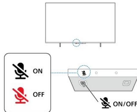
Под чувствительным микрофоном расположена кнопка-переключатель, которая отвечает за включение/отключение микрофона. Когда микрофон включен, LED-индикатор будет отключен. Если отключить микрофон с помощью кнопки-переключателя, LED-индикатор будет гореть ровным светом, напоминая вам, что микрофон не готов к работе.
