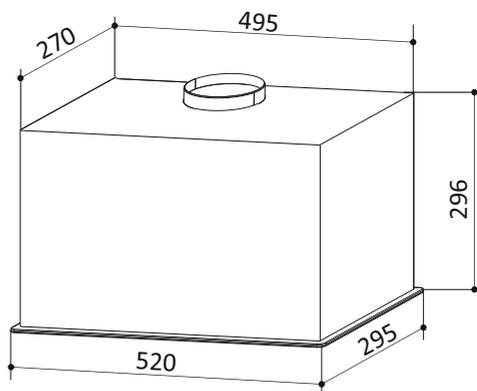
Рис. 1 Внешний вид кухонной вытяжки и схема размеров
