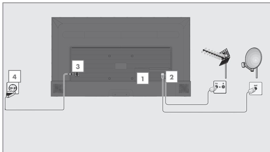
1 Для приема цифровых спутниковых каналов (DVB-S) подключите кабель спутниковой антенны к разъему антенны **»SATELLITE«** на корпусе телевизора;
