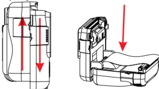
Шаг 3: закройте отсек, соединив обе части камеры в обратном порядке.
