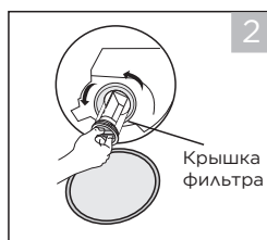
Откройте крышку фильтра, повернув против часовой стрелки
