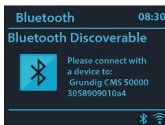
В режиме Bluetooth вы можете включить функцию Bluetooth вашего устройства Bluetooth. Нажмите и удерживайте »BTPAIR«, чтобы включить функцию обнаружения Bluetooth. На вашем устройстве Bluetooth выполните поиск в системе HiFi Grundig CMS 5000 для сопряжения. Когда устройство ожидает сопряжения, внизу появляется мигающий значок Bluetooth. Если сопряжение выполнено успешно, значок Bluetooth перестанет мигать. Управляйте воспроизведением музыки с вашего устройства Bluetooth.
