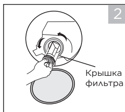
Откройте крышку фильтра, повернув против часовой стрелки
