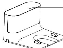
Индикатор зарядной станции горит: зарядная станция подключена к источнику питания
