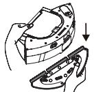
① Снимите моющий модуль
