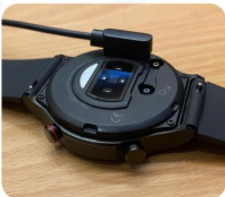
2. Используйте для зарядки USB-порт компьютера, портативное зарядное устройство или сетевой блок, чьи параметры НЕ превышают 5V, 2A. Рекомендуемые параметры сетевого блока – 5V, 1A
