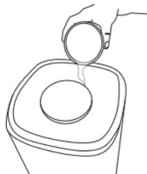
Также Вы можете снять корпус прибора, крышку с помпой и залить воду напрямую в резервуар для воды. После чего собрать устройство обратно.
