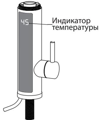
Во время нагрева воды загорается светодиодный индикатор температуры воды. На цифровом дисплее будет отображаться температура воды на выходе из нагре-
