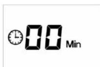
По завершению работы нагревание прекратится автоматически. На дисплее появятся цифры “00” и изображение часов, а звуковой сигнал прозвучит пять раз.
