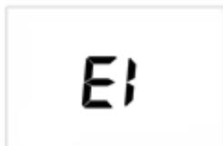
Фритюрница оборудована аварийным отключением, которое защищает оборудование от перегрева, если в нем нет масла. На дисплее в этом случае появляются символы “E1” и звуковой сигнал звучит непрерывно. Чтобы переключить аппарат в режим ожидания, нажмите на любую кнопку.
