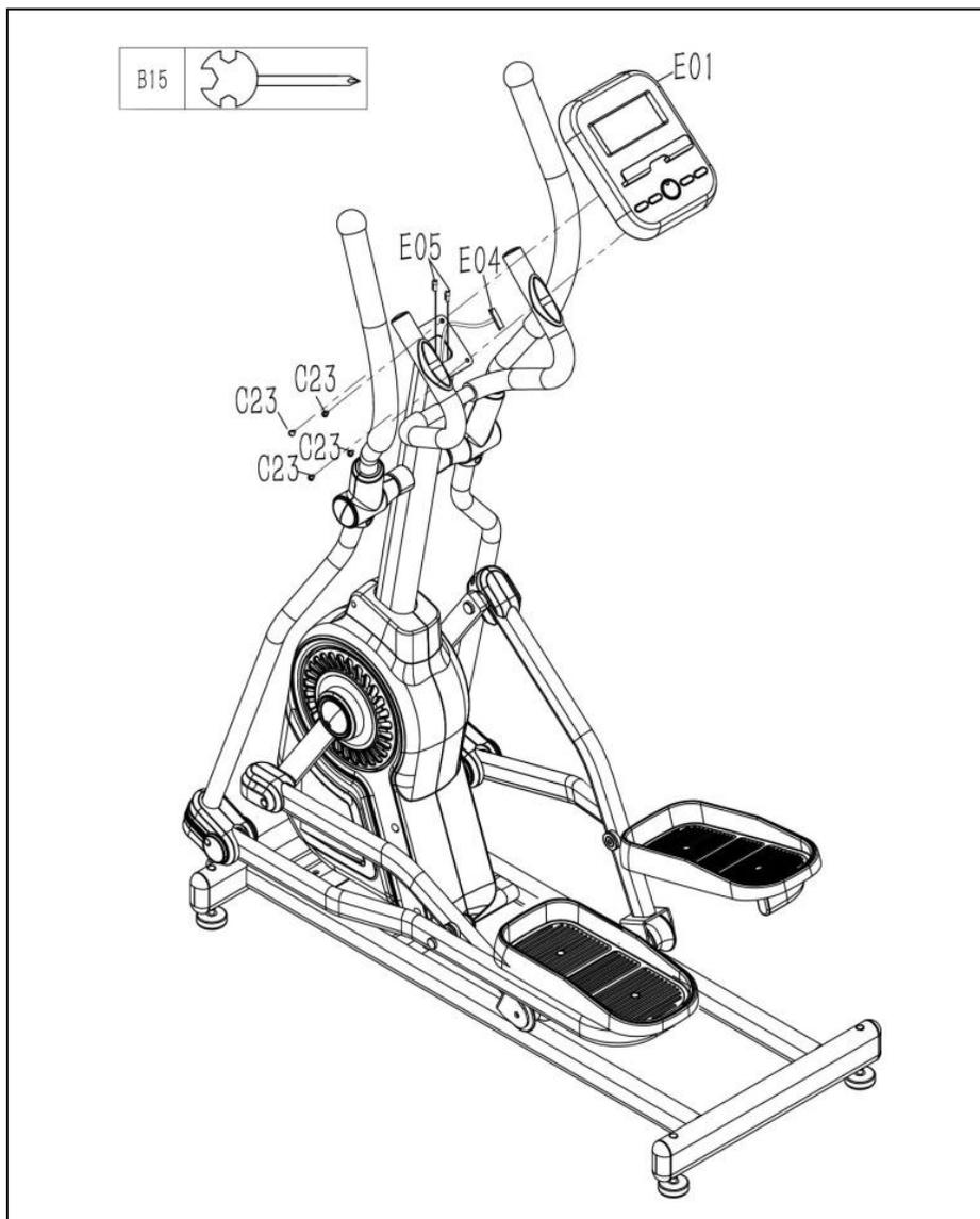
Рисунок 10 – Установка консоли
