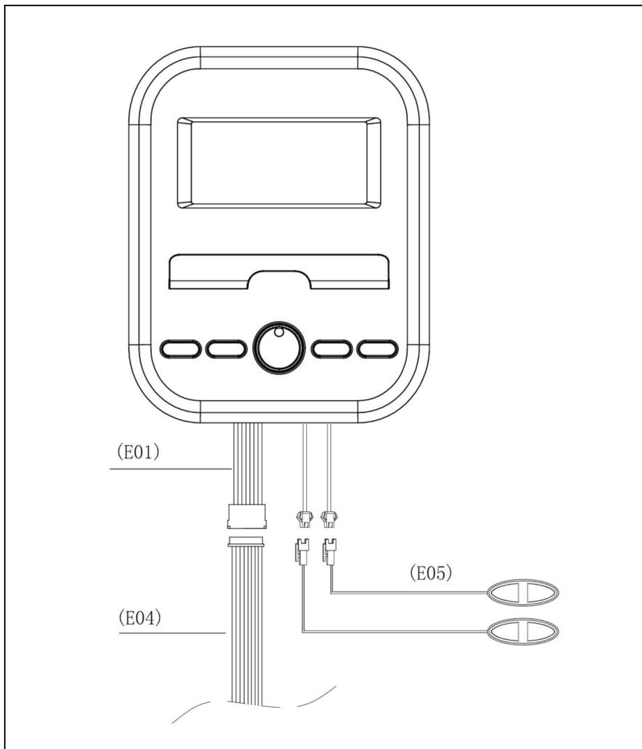
Рисунок 9 – Подключение консоли
