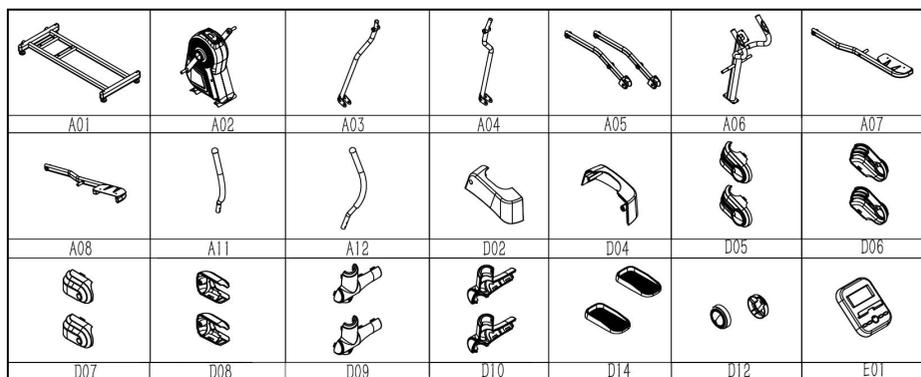
Рисунок 1 – Комплектация эллиптического тренажера
