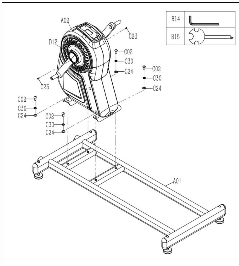
Рисунок 3 – Установка рамы
