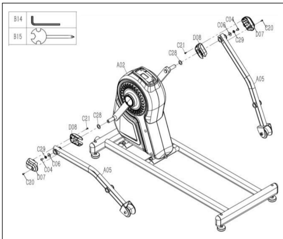
Рисунок 4 – Установка опор шатуна и кожухов
