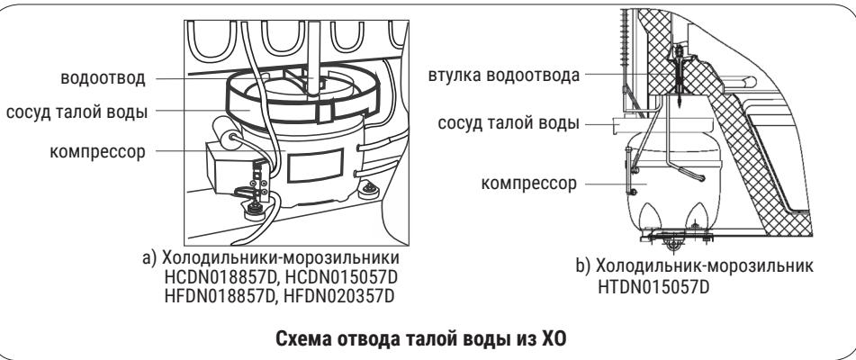
Схема отвода талой воды из ХО
