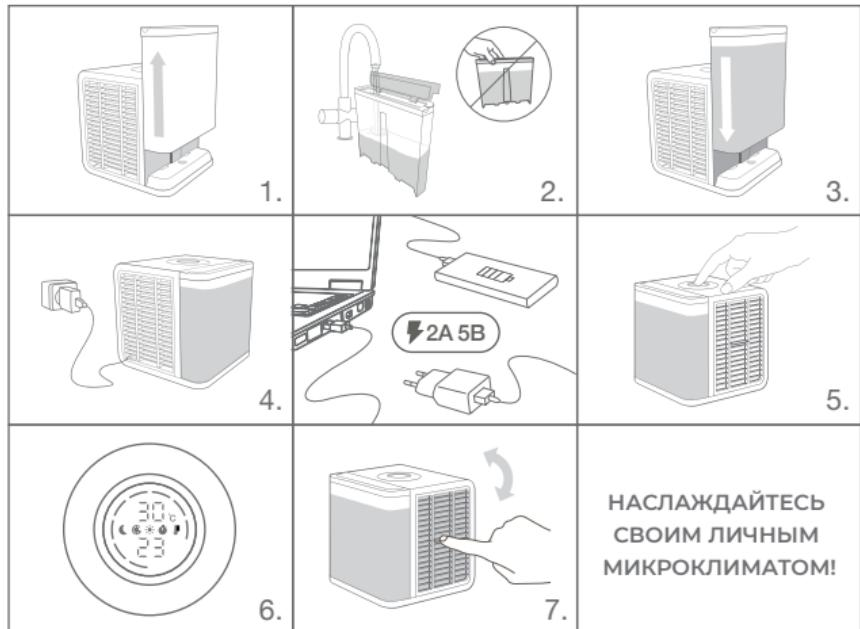
**СОВЕТ:** Чтобы продлить время работы устройства до следующего наполнения, дождитесь, когда картридж полностью наполняется водой (это занимает до 10 минут) и долейте воды в резервуар
