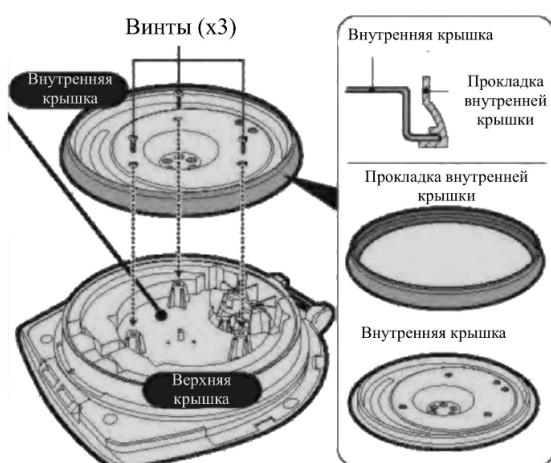
**Если прокладка внутренней крышки износилась или стала белой, между корпусом и верхней крышкой при наклоне термопота может протекать горячая вода. Это может привести к ожогу.**
