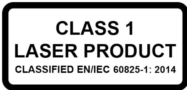
Это устройство является лазерным изделием класса 1 в соответствии с EN/IEC 60825-1:2014. Это устройство соответствует нормативным характеристикам FDA для лазерных изделий, за исключением соответствия IEC 60825-1 Ed. 3, как указано в *Laser Notice No. 56* от 8 мая 2019 г.
