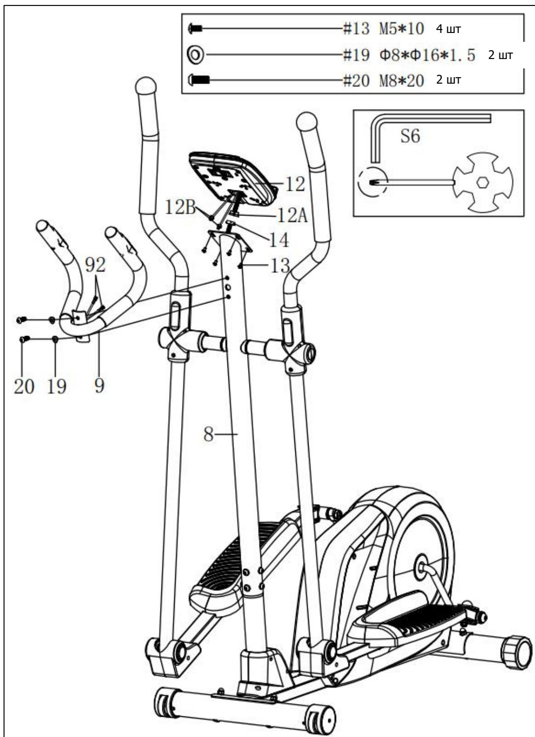
а. Пропустите кабели датчиков измерения пульса (92) через отверстие в стойке руля (8), затем установите руль (9) на стойку (8) и закрепите с помощью болтов (20) и дуговых шайб (19).
