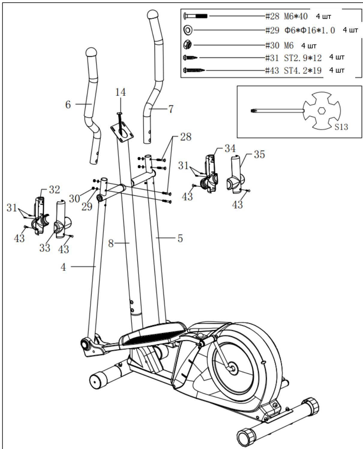
Установите верхние поручни (6,7) на поручни (4,5) и закрепите с помощью болтов (28), дугообразных шайб (29) и гаек (30). Затем установите кожухи левого поручня (32,33) и правого поручня (34,35) на левый поручень (4) и правый поручень (5), закрепите детали с помощью винтов (31) и саморезов (43).
