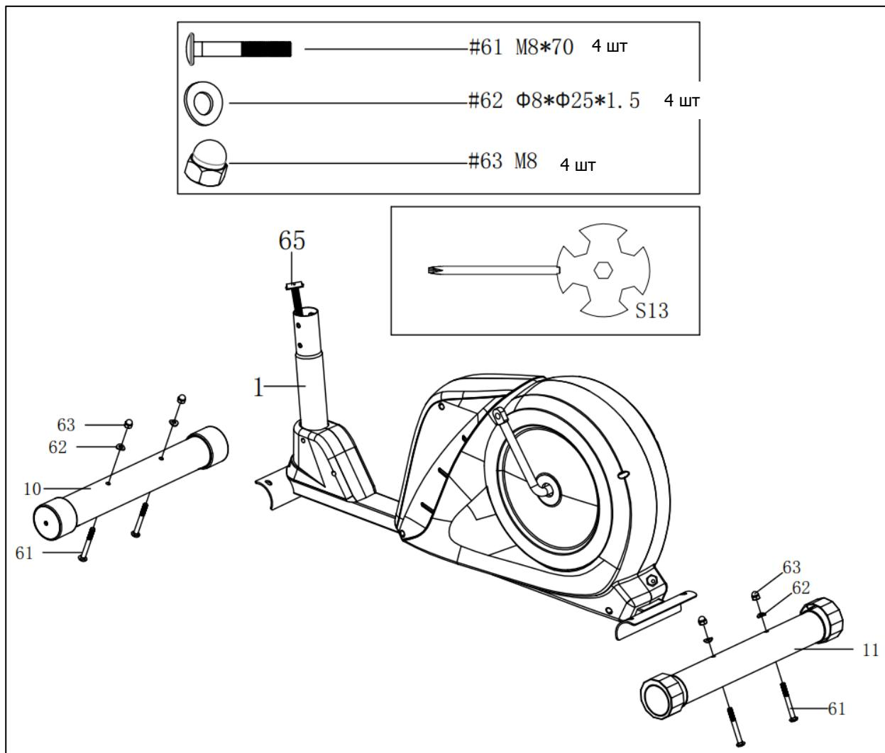
Установите передний стабилизатор (10) и задний стабилизатор (11) на основную раму (1) и закрепите с помощью болтов (61), дуговых шайб (62) и гаек (63).
