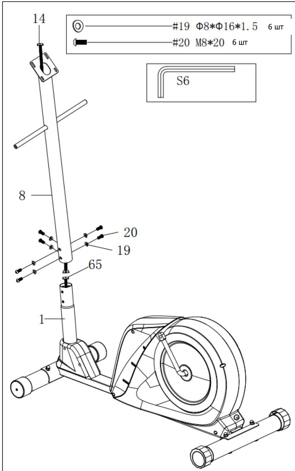
Соедините кабель (14), выходящий из вертикальной стойки с кабелем основной рамы (65), а затем установите вертикальную стойку (8) на основную раму (1) и закрепите с помощью болтов (20) и дуговых шайб (19).
