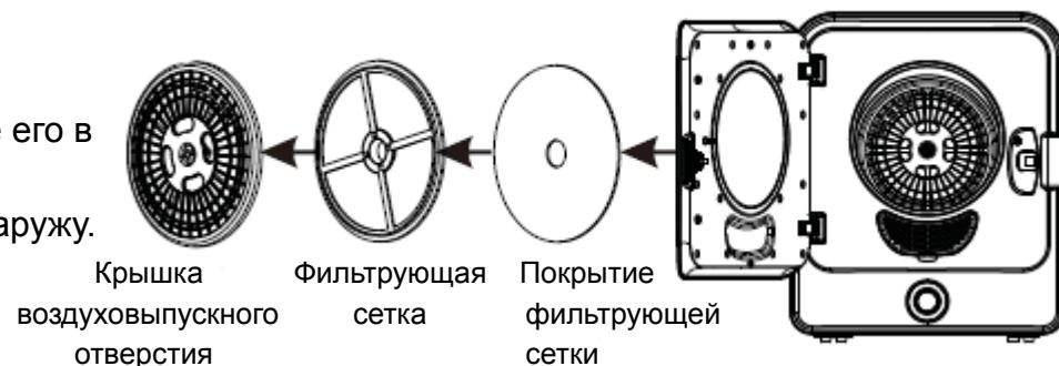
В. Очистка линии от крошек: снимите крышку воздуховыпускного отверстия, фильтровальную сетку и сетку фильтра соответственно. И с помощью мягкой щетки или пылесоса очистите линию от крошек на сетке фильтра и покрытия. Будьте осторожны, чтобы не повредить фильтровальное покрытие.
