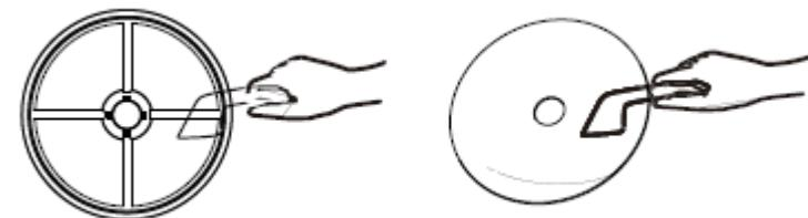
С. Установка фильтрующего экрана: После очистки соберите фильтр в порядке расположения фильтрующего экрана, хлопкового фильтрующего экрана и вытяжки для выпуска воздуха, затем вставьте изогнутую центральную часть фильтрующего экрана в выпуклую центральную часть барабана.
