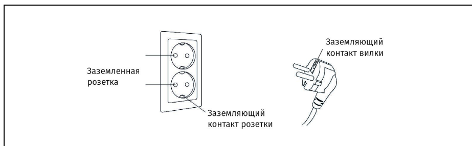
Рисунок 33 — Правильное заземление массажного кресла
