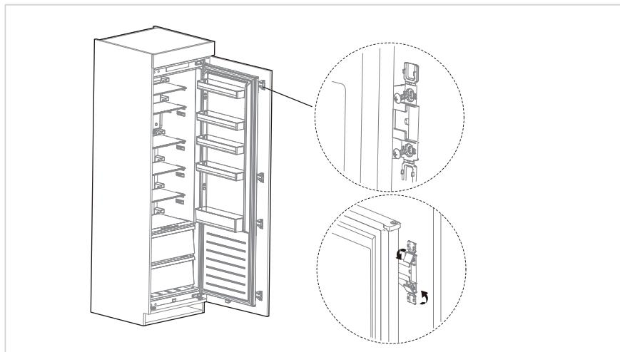
5. Возьмите уплотнительную ленту из пакета принадлежностей и установите в щель между холодильником и установочным шкафом. Установка завершена.
