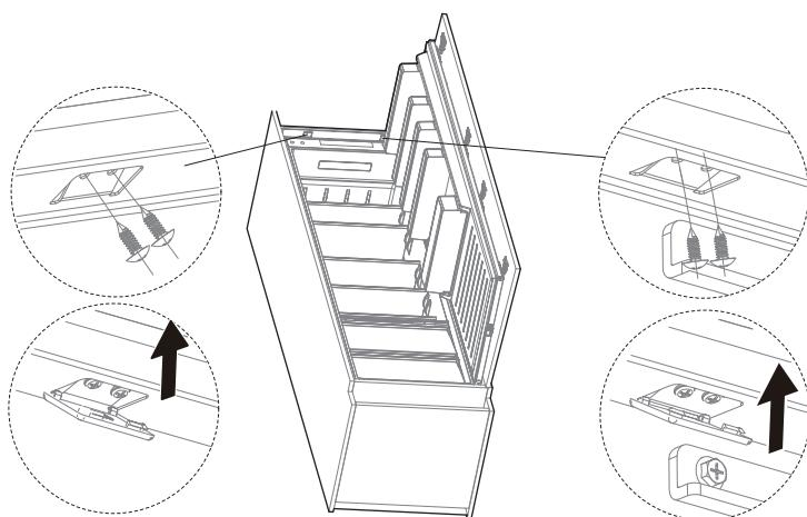
4. Откройте дверь установочного шкафа на максимальный угол. Затем откройте дверь холодильника. Выдвиньте крепление таким образом, чтобы внутренний угол совпал с краем двери холодильника. Прикрепите крепления к двери установочного шкафа и закройте винты заглушками.
