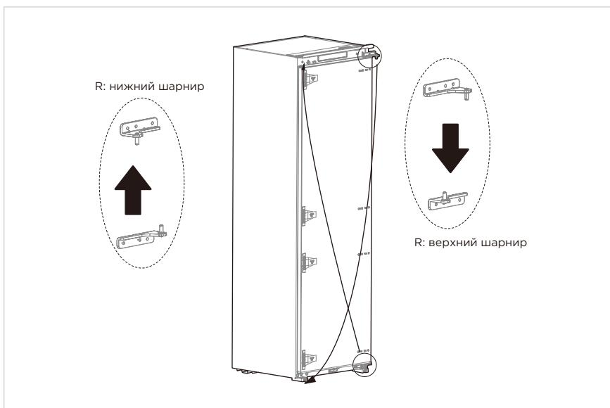
5. Снимите 4 крепления с двери холодильника, поверните их на 180°, и затем установите их на противоположной стороне двери.
