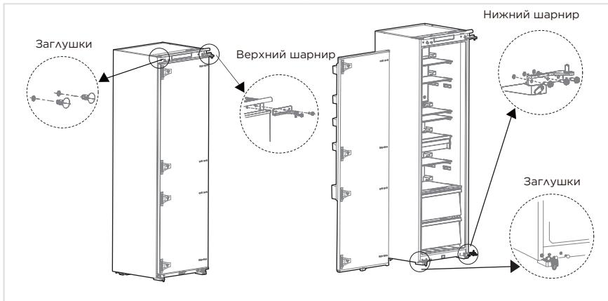
4. Поменяйте местами R:нижний шарнир and R:верхний шарнир, затем установите их согласно рисунку ниже. Закройте отверстия заглушкиами.
