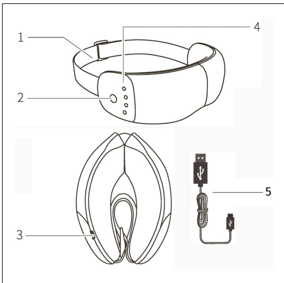
Рисунок 1 — Устройство массажера
