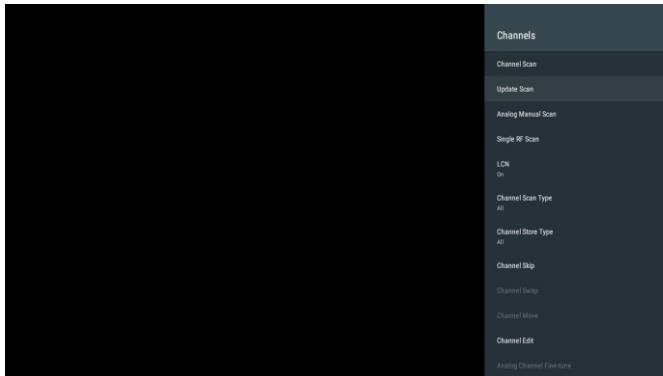
**Описание функции:** для настройки канала отключите LCN и выберите Channel Scan. Информация о процессе настройки канала, состоянии цифровых и аналоговых каналов.
