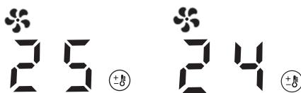
Если установленная температура **на 1–2 °С выше** температуры окружающей среды, прибор будет работать в режиме низкого нагрева.
