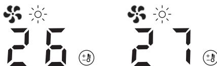
Если установленная температура **выше более чем на 3 °С** температуры окружающей «среды» прибор будет работать в режиме высокого нагрева.
