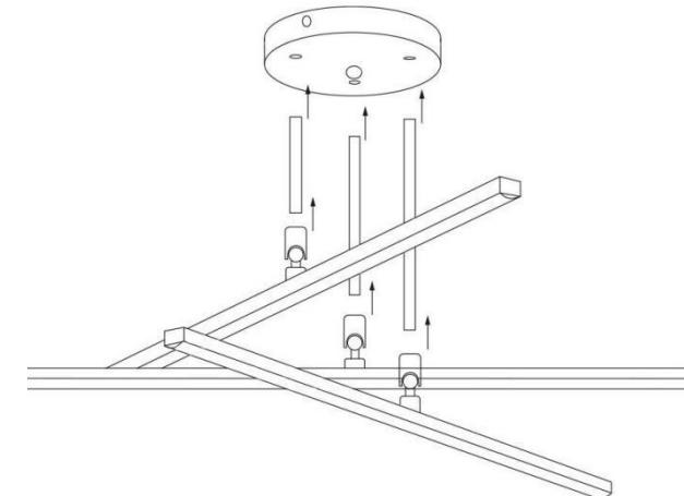
Используйте гайки для фиксации рожки в потолочной чаше.
