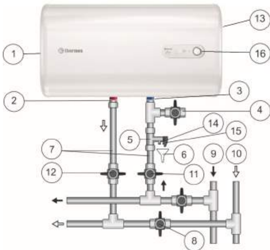
Рисунок 1. Схема подключения ЭВН к водопроводу в вертикальном положении
