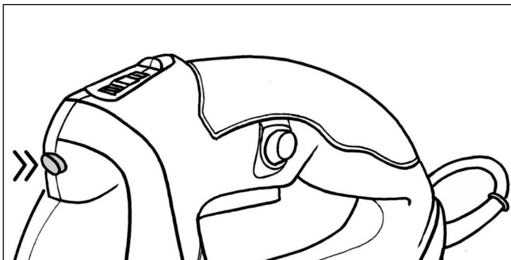
Рис. 8. Включение лазера/подсветки на модели Л-100/850
