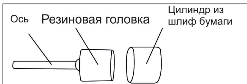
Рис.6 Установка цилиндра из шлиф бумаги
