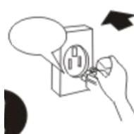
Перед включением прибора в сеть электропитания убедитесь, что напряжение и частота электросети соответствует указанным на маркировке изделия. Подключайте прибор к розетке с заземлением. Подключайте прибор только к источнику переменного тока.
