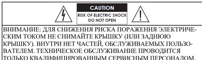
Значок молнии со стрелкой внутри треугольника предназначен для предупреждения пользователя о наличии неизолированного "опасного напряжения" внутри корпуса изделия, которое может иметь достаточную величину, чтобы создать риск поражения электрическим током для людей.
