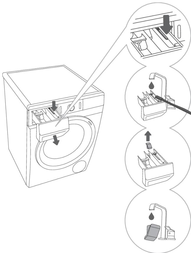
**1** Нажмите на язычок и полностью извлеките дозатор из отсека.
