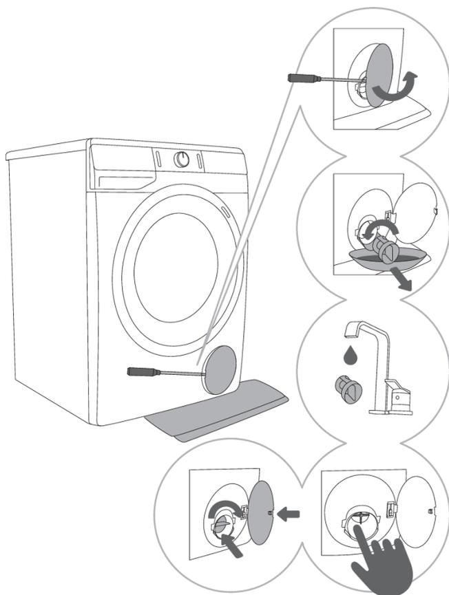
**1** Откройте крышку фильтра насоса с помощью плоской отвертки или подобного инструмента.
