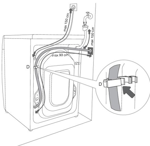
**Д** Сливной шланг должен быть закреплен и прикреплен к задней стенке стиральной машины, как показано на рисунке.
