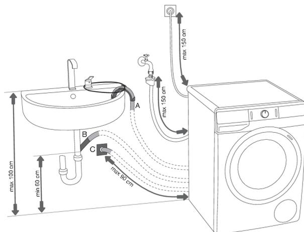
**А** Закрепите сливной шланг на раковине или ванне. Протяните шнур через пластмассовый кронштейн и закрепите сливной шланг так, чтобы он не соскальзывал на пол.
