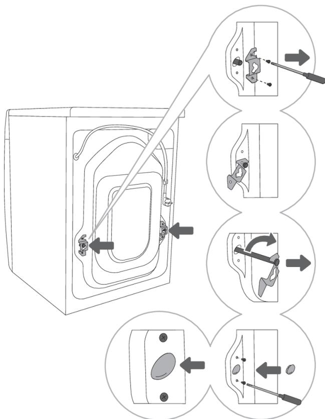
**1** Отодвиньте шланги и открутите винты на задней стенке стиральной машины. Снимите две крепежные скобы.
