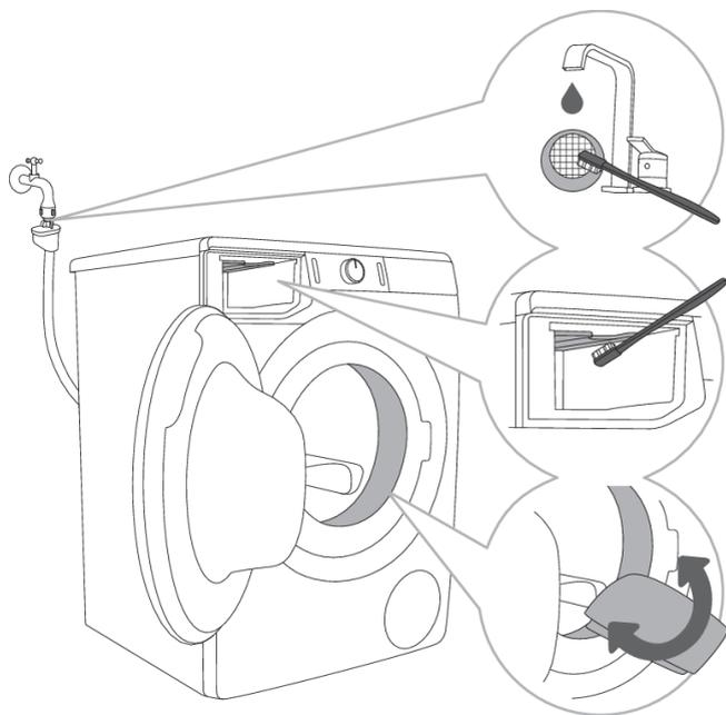
**1** Тщательно промойте фильтр заливного шланга под струей воды.
