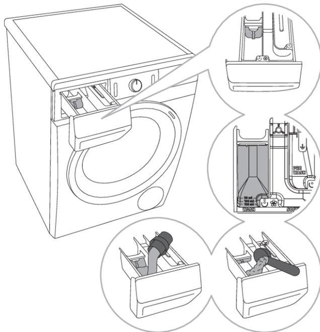
**1** В дозаторе моющих средств предусмотрена специальная пластинка, которая позволяет заливать в левое
