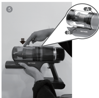
Вставьте сухой фильтр в пылесборник и установите в основание устройства до щелчка.
