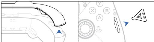
2. Снимите магнитную переднюю панель потянув ее вверх на рукоятке, после этого достаньте отвертку для регулировки.
