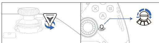
3. Отрегулируйте сопротивление при помощи отвертки. Повороты против часовой стрелки ослабляют, по часовой увеличивают сопротивление. Ориентируйтесь по маркировке. В нижней части есть насечки, указывающие на уровень сопротивления.
