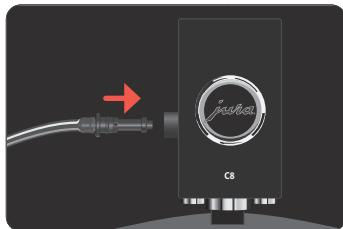
**i** Система приготовления молока кофемашины C8 оснащена соединительной деталью **HP1** и сменным дозатором молока **CX1**.
