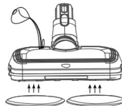
Вставьте насадку для влажной уборки во входное отверстие телескопической трубы до щелчка.
