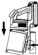
4. Поверните фильтр грубой очистки (12) против часовой стрелки и извлеките его из контейнера. Также извлеките фильтр предварительной очистки (10).
