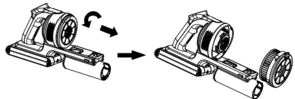
6. Промойте контейнер для сбора пыли, фильтры предварительной и грубой очистки под проточной водой.
