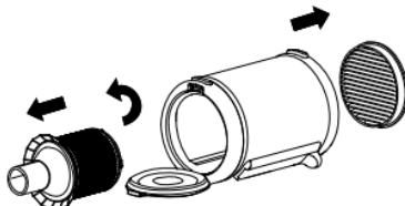
5. При необходимости извлеките, тщательно очистите и промойте HEPA-фильтр. Для этого поверните против часовой стрелки HEPA-фильтр и вытащите его из основного блока.
