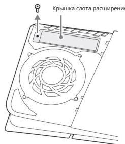
3 Удалите винт и прокладку, а затем отрегулируйте проставку до размера SSD M.2.
