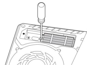
6 Прикрепите крышку слота расширения и затяните винт.
