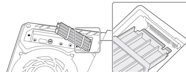
5 Наклоните твердотельный накопитель M.2 вниз и закрепите его винтом.
