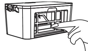
7. Вы можете промыть пылесборник и фильтры водой, но не забудьте ТЩАТЕЛЬНО высушить их перед повторной установкой в пылесос (не очищайте фильтры при помощи моющих средств).
