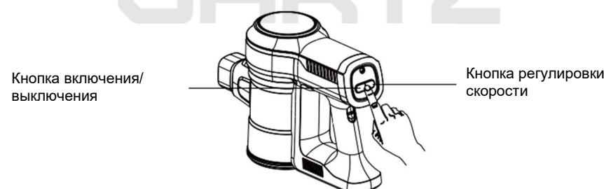
При нажатии на кнопку регулировки скорости «+/-», пылесос будет работать на высокой, средней или низкой скоростях.
