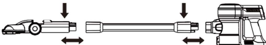
Аналогичным образом вставьте насадку для влажной уборки пола в металлическую штангу, до щелчка.
