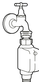
Заливной шланг с защитой от протечек
