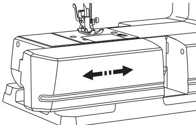
Удерживая съемный столик в горизонтальном положении, потяните его влево для отсоединения от машины.
