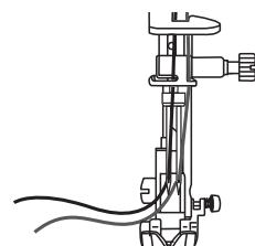
Протяните обе нити назад под нижней поверхностью прижимной лапки.
