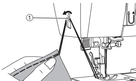
9. Вытяните обе нити влево и заведите их за специальный нож для обрезки, расположенныйный на корпусе машины. Потяните нити вниз для обрезки.
