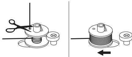
8. После намотки нескольких оборотов остановите машину и обрежьте конец нити как можно ближе к отверстию в шпульке. Продолжите процесс намотки пока шпулька не заполнится. После заполнения шпульки ее вращение замедляется. Остановите машину, отпустив педаль. Отведите шпиндель намотки шпульки влево.
