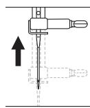
2. Поверните маховое колесо на себя (против часовой стрелки) и поднимите иглу в крайнее верхнее положение.
