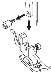
Снимите прижимную лапку и держатель лапки.
