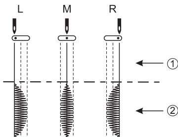
Вы можете устанавливать иглу в нужное положение с помощью регулятора положения иглы.
