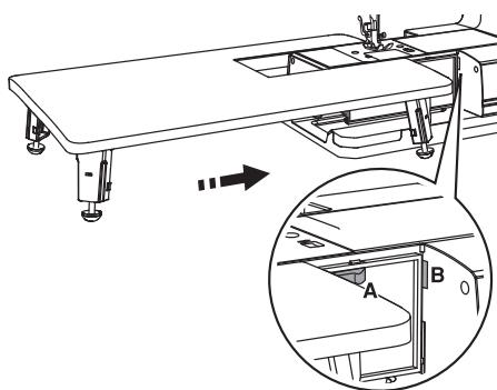
Аккуратно установите на рукавную консоль большой столик ножками вниз так, чтобы выступ на столике (A) вошел в паз на корпусе машины (B).
