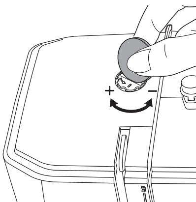
Давление прижимной лапки было отрегулировано при сборке машины и установлено для шитья тканей средней плотности.
