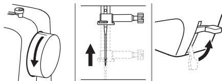
8. Поверните маховое колесо на себя (против часовой стрелки) и поднимите иглу. Поднимите подъемный рычаг прижимной лапки и вытащите ткань.
