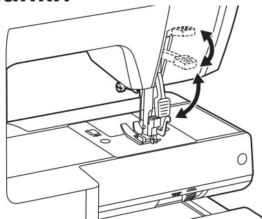
Рычаг подъема прижимной лапки используется для подъема или опускания лапки.
