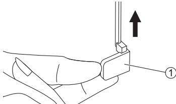
Поднимите прижимную лапку и обрежьте нить. Для повторного обметывания той же петли поднимите лапку (она вернется в исходное положение).
