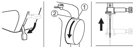
Опустите рычаг подъема прижимной лапки. Поднимите иглу в крайнее верхнее положение, вращая маховое колесо на себя до тех пор, пока рискса не совпадет с отметкой на корпусе машины.
