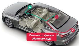
Рекомендуемое место монтажа второй камеры
