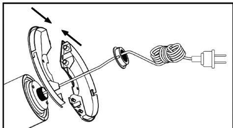
4. Присоедините опору к основанию прибора и зафиксируйте пластиковой гайкой (по часовой стрелке)
