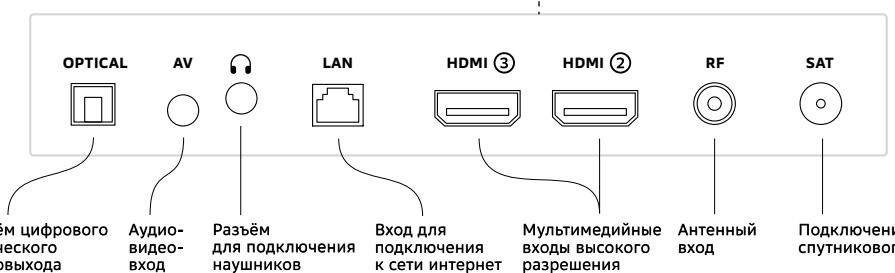
Внешний вид телевизора и вид телевизора со стороны корпуса зависит от модели устройства. Телевизор на рисунке приведен схематически, только для обозначения местоположения панелей управления и разъёмов. Изображение панелей управления и разъёмов соответствует вашей модели и является фактическим.
