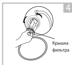
Откройте крышку фильтра, повернув против часовой стрелки
