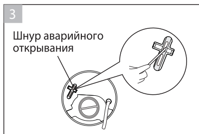
3. Вставьте в отверстие шнура плоскую отвертку или подобный неострый предмет. Нажмите вниз (в направлении стрелки). Если дверца разблокировалась, индикатор блокировки погаснет.
