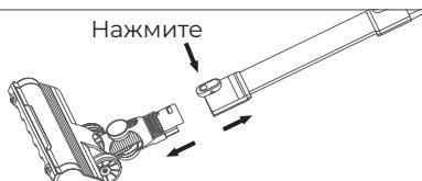
Сдвиньте кнопку фиксации ролика, достаньте его и почистите. После очистки установите ролик и щетку в обратном порядке.
