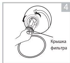
Откройте крышку фильтра, повернув против часовой стрелки
