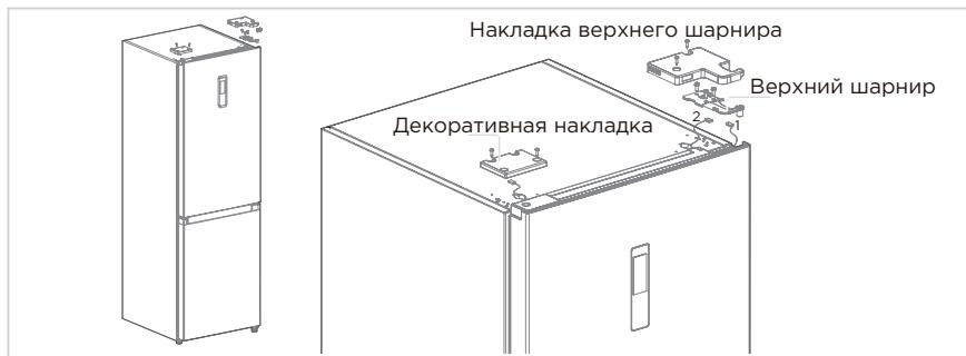
3. Снимите дверь холодильной камеры. Будьте осторожны, не потеряйте мелкие детали (втулку шарнира, стопор). Отвинтите средний шарнир и снимите декоративную накладку на другой стороне корпуса.
