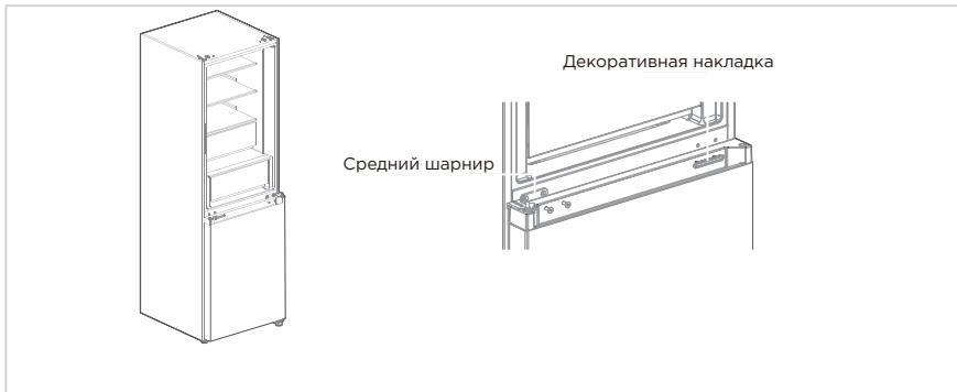
8. Возьмите верхний левый шарнир и накладку шарнира из комплекта принадлежностей. Установите дверь холодильной камеры на средний шарнир, затем установите на место верхний левый шарнир. Соедините разъем провода 4 с разъемом провода 1. Установите декоративную накладку на старом месте шарнира справа (примечание: при установки декоративной накладки справа срежьте с нее два штырька, как показано на изображении).
