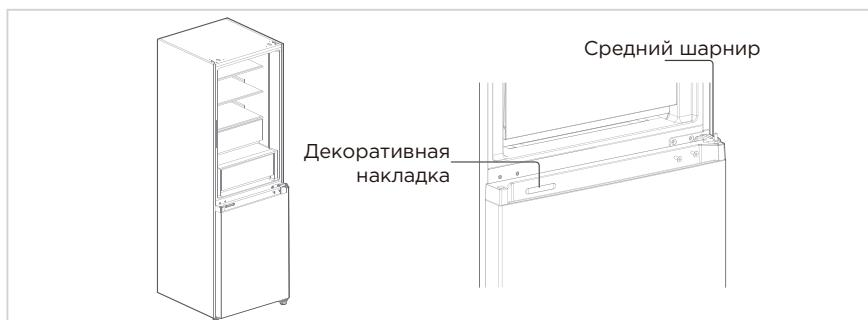
4. Снимите дверь холодильной камеры. Будьте осторожны, не потеряйте мелкие детали (втулку шарнира, стопор). Отвинтите нижний шарнир и регулируемую ножку с низа холодильника. Отвинтите от шарнира ось и переустановите ее на другой его стороне (см. изображение). Поменяйте шарнир и ножку местами и установите их каждый на новой стороне.
