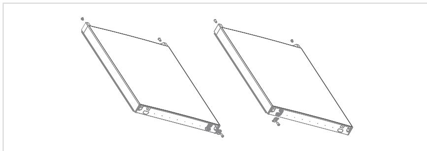
7. Установите дверь морозильной камеры на нижний шарнир, затем установите средний шарнир на новое место. Закройте старые отверстия декоративной накладкой.
