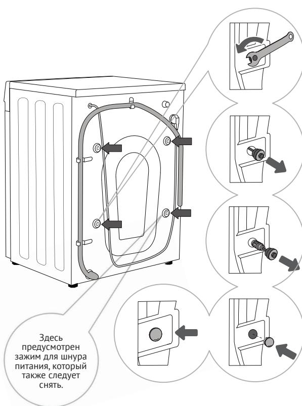
1. Сдвиньте в сторону шланги и с помощью гаечного ключа выкрутите 4 болта на задней панели прибора, повернув их против часовой стрелки, как показано на рисунке. Выкрутите их примерно на 30 мм.
