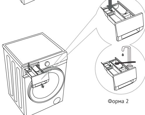
1. Чтобы извлечь лоток для моющих средств из корпуса, нажмите на небольшой язычок.
