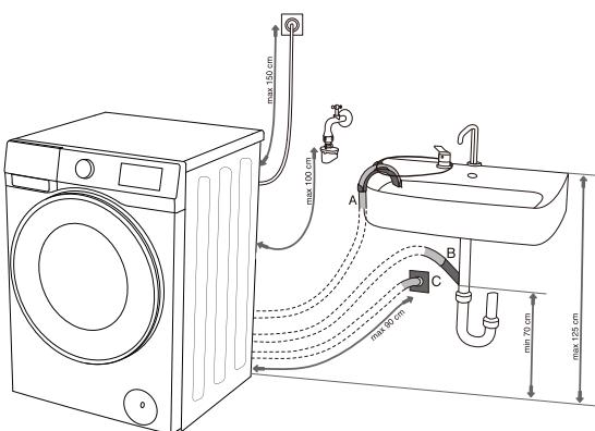
С. Шланг для слива воды можно также подсоединить к настенному сифону; такой сифон должен быть качественно установлен, чтобы обеспечить нормальный слив воды.
