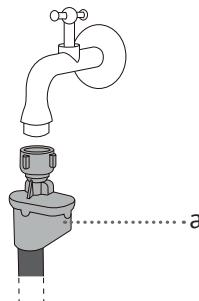
⇨ Не погружайте шланг подачи воды с системой Aqua stop в воду, так как в нем находится электромагнитный клапан.
