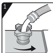
Закройте кран и открутите резьбовое соединение шланга и крана.
