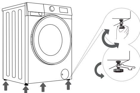
1. Вращайте регулируемые ножки, чтобы выровнять стиральную машину. Ножки позволяют регулировать высоту на +/- 2 см.
