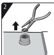
С помощью плоскогубцев снимите сетчатый фильтр со штуцера стиральной машины.
