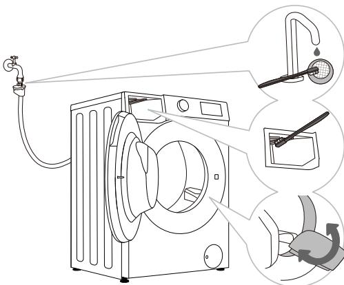
1. Регулярно промывайте сетчатый фильтр под проточной водой.
